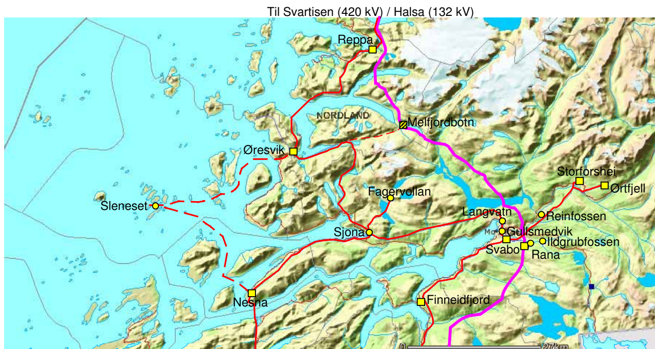
Figur 1: Tilknytning av det nye vindkraftverket på Sleneset til regional- eller sentralnettet i området. Gule firkanter angir eksisterende transformatorstasjoner, mens gule sirkler angir kraftstasjoner. Linjene er avmerket som røde (132 kV) og rosa (420 kV) streker. (Bakgrunnskart: NVE Atlas)
